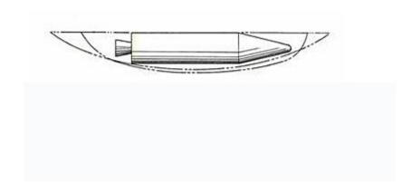
[Figure 4] Защита спутника от радарного излучения с помощью экрана (патент компании Rockwell Int . № 4947174 от 7.8.1990, подан 24.2.1969)
