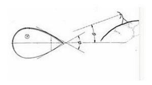
*[Figure 3]* Подавление сигнатуры у спутника конусовидной формы (патент компании Aerospace Corp № №3233238 от 1.2.1966, подан 1.6.1962)
