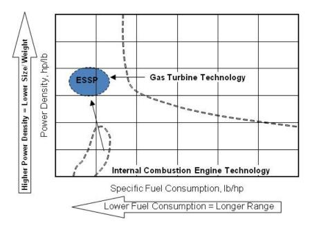
Figure 19. Efficient Small-Scale Propulsion (ESSP).
